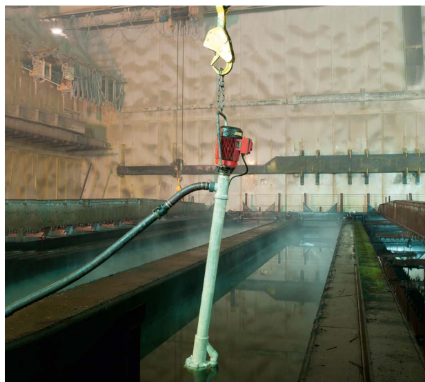
F 640 – Выкачивание разбавленной серной кислоты.
