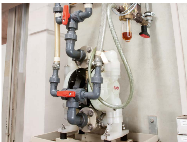
FDM Выкачивание химического никеля для гальванической ванны.
